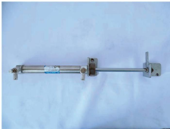
Figura 4.8 Acoplamiento montados sobre el cilindro
