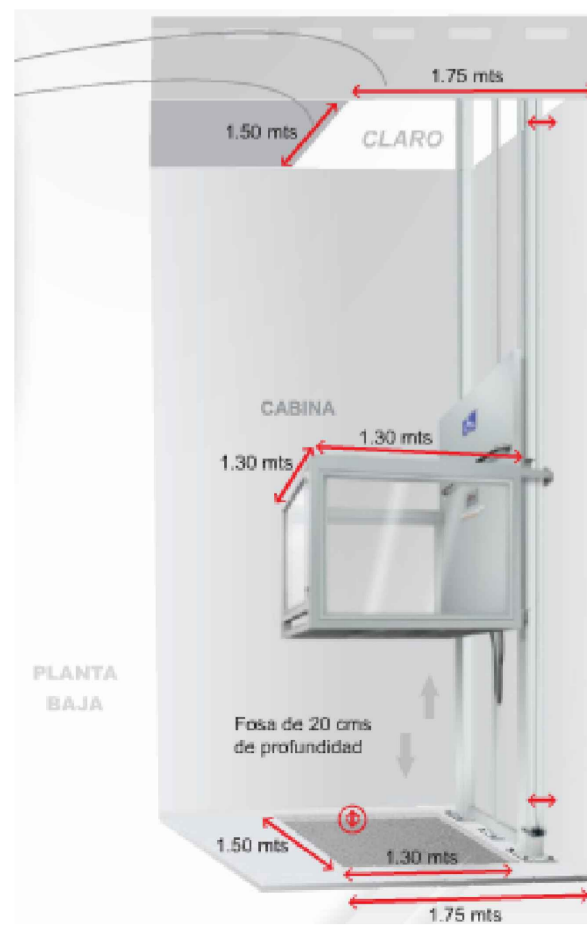
ELEVADOR TECNORAMPA, MEDIDAS DE CABINA 1.30x1.30 mts., MEDIDAS DE CLARO 1.50x1.75 mts. PROFUNDIDAD DE LA FOSA: 20 cm. CAPACIDAD 500 kg. OPERACION ELECTROHIDRAULICA FIJACION CON TAQUETES EXPANSIVOS, 110 V REQUERIDOS.
