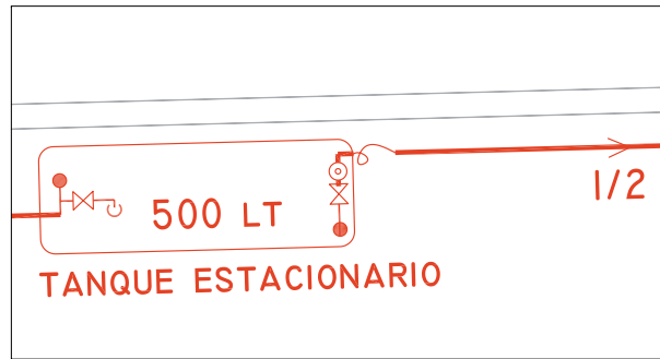
DETALLE INSTALACIÓN DE GAS - TANQUE ESTACIONARIO ESC 1:50
