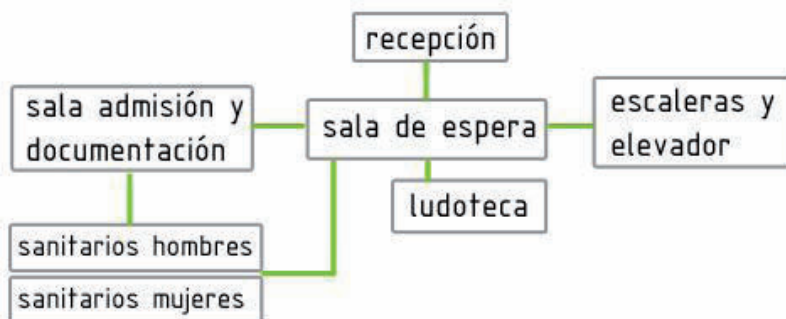
DIAGRAMA DE FUNCIONAMIENTO. AREA DE ACCESO Y CONTROL. EDIFICIO DISTRIBUCIÓN Y DIAGNÓSTICO_ (IMAGEN 79)
